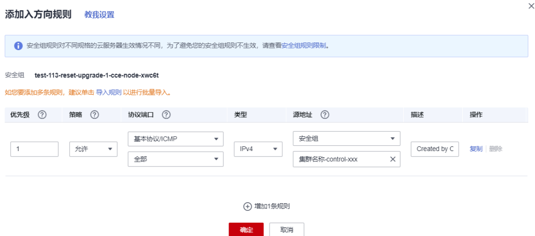
图 2-39 对 Master 安全组放通 ICMP 协议
