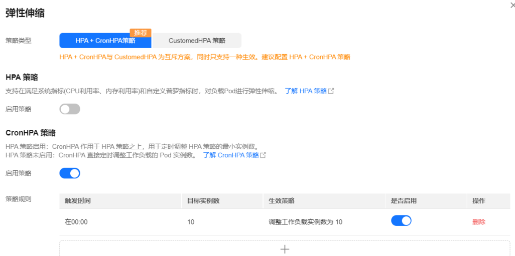
图 10-10 使用 CronHPA 调整工作负载实例数
